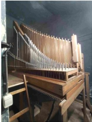
wurden in der Werkstatt in Bautzen überarbeitet. Dabei traten auch vorher nicht sichtbare Schäden z.B. an der Pedalklavatur zutage. Neben der Reinigung der gesamten Orgel wurden Teile ausgebessert oder neu gefertigt. Im März begann der Wiedereinbau der Orgel. Nach Abschluss der mechanischen Arbeiten erfolgten das Intonieren und die Generalstimmung der 5 Register. Am Gründonnerstag
